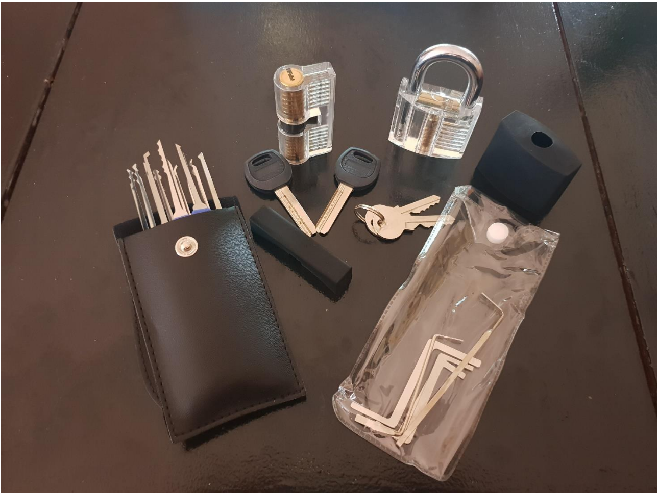
Bild 2.1: Set mit Übungsschlössern und Werkzeugen
